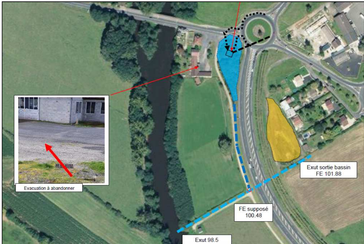
Gestion des eaux pluviales au niveau du pont de Risquetout et du giratoire sur la RD 901
